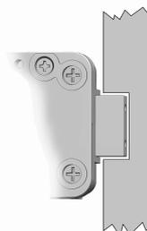
**Provare alcune volte l'apertura della serratura prima di chiudere la porta.**
