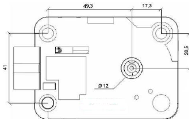
Il diametro massimo del foro per il passaggio della chiave deve essere 12mm. Fissare il copritoppa, assicurandosi che la tacca per l'inserimento della chiave (change index) sia correttamente posizionato in base alla direzione di montaggio della serratura.
