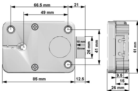
Sul chiavistello della serratura StraightBolt possono essere fissate delle barre di rimando: il massimo carico applicabile è di 2.5N.
